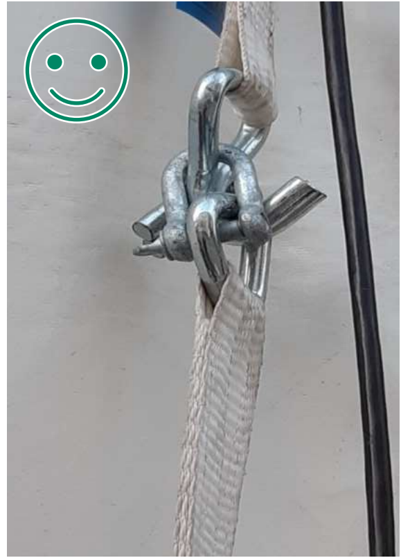
Kuva 8 HYVÄ TAPA. Koukut lukittu sakkellilla.
