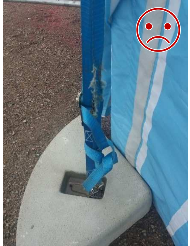
Kuva 10 Ei NÄIN. Kuormaliina on kulunut.
